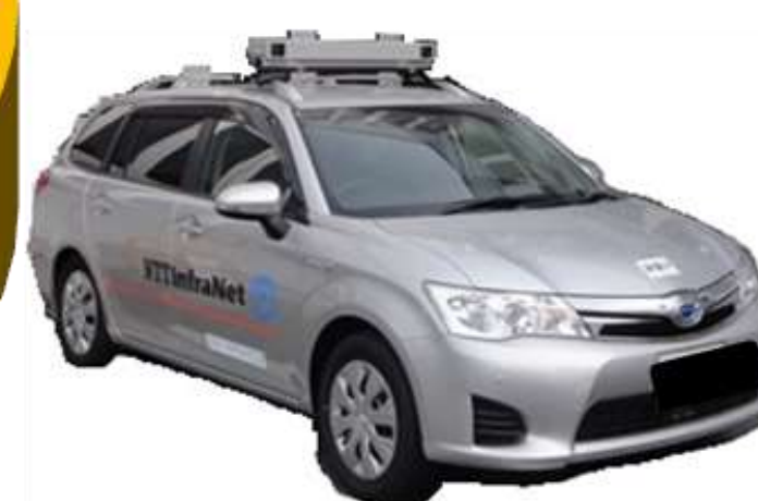
メンテナンス走行用MMS (車両コストを大幅に低減)
