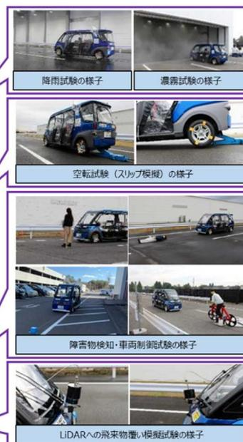
**図 6. レベル 3 に向けた公的研究機関 (JARI) 等での主な車両性能試験の概要**
