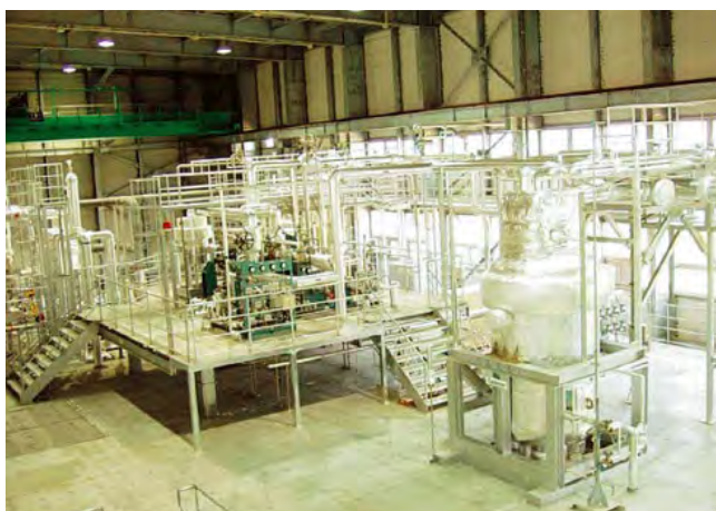
図 2.2.24 佐賀大学海洋エネルギー研究センター (30kW 海洋温度差発電システム)
