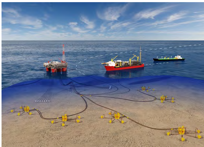
図3.2.5 サブシー生産システムのイメージ (出典：INPEX ウェブサイト)
