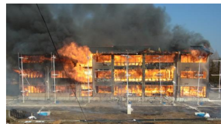
実大建築での燃焼試験
