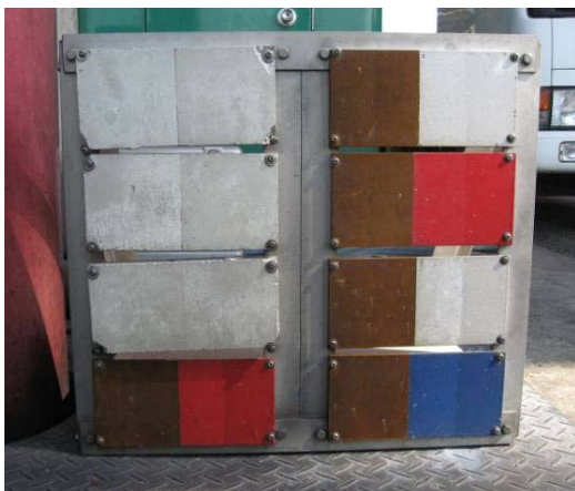
写真-7 高速道路料金所における曝露試験結果(1ヶ月後)
