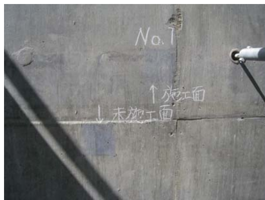
写真-11 メチレンブルーによる防汚性能確認状況(5時間後)
