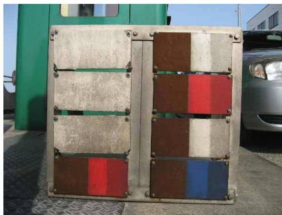
写真-8 高速道路料金所における曝露試験結果(3ヶ月後)
