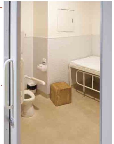
⑨ トイレは、オストメイト用便器、幼児用便器など、数種類の便器が一箇所にそろっており、介助用のベッド等も備えられている。また、入口はカーテンではなく、引き戸になっている。
