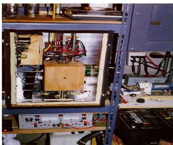
图1.4. 埃德蒙·斯托姆斯（Edmund Storms）建造的量热计。由于停电会毁掉实验，所以使用了右下角所示的DieHard®不间断电源，实验尽量使用普通的材料和仪器。然而实验从来都不便宜，无法小打小闹。
