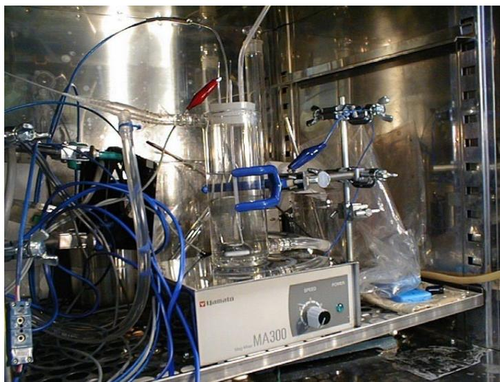
图2.5. 水野实验室空调控制柜中的辉光放电装置，J. Rothwell摄。
