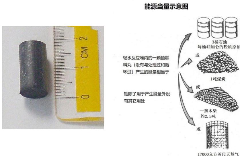
图3.1. 一个仿制的铀核燃料芯块（由橡胶制成），图源自American Nuclear Society, 555 North Kensington Avenue, La Grange Park, Illinois 60526.
