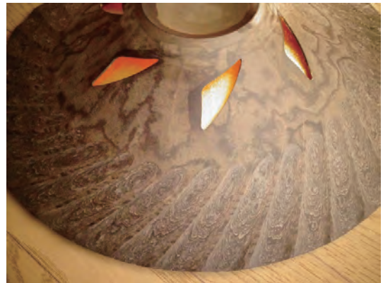
図12 旋形の形成（刃物による切削）
