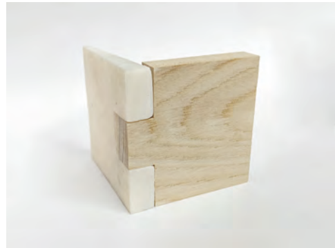
図9 三枚組接ぎ(木材と3Dプリント造形物)
