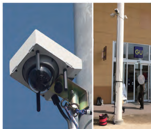
図3 「View Pole」カメラ部および、設置状況
