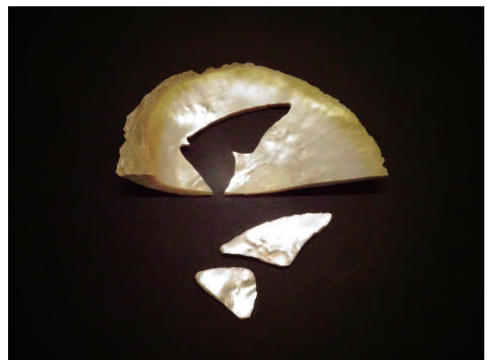
図14 黄蝶貝の部材加工（原貝の南洋真珠貝から切り出し）
