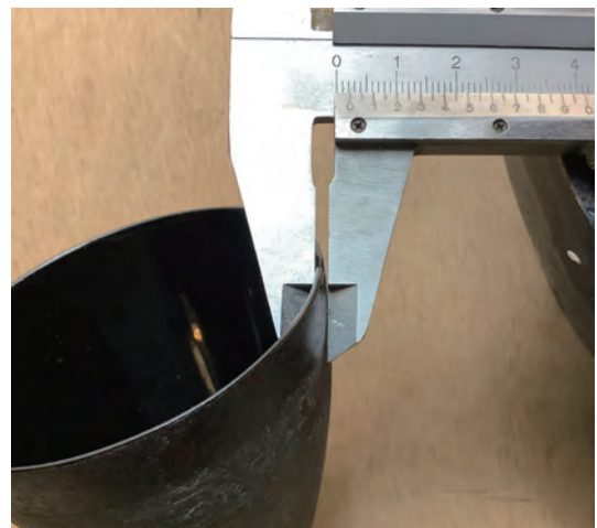
図2 積層構造の厚み 約2mm
