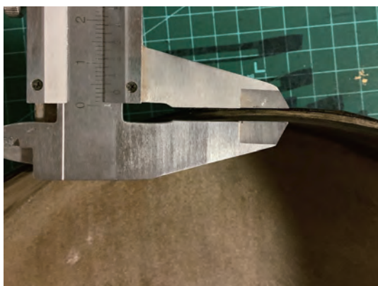
図8 試作3 胎の厚み3mm
