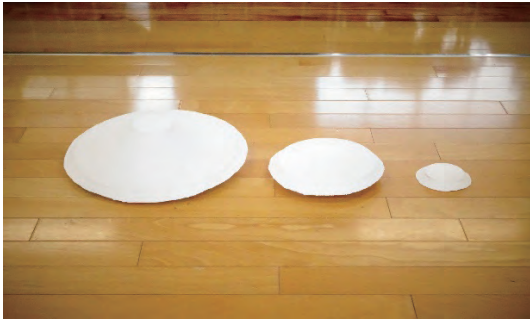
図3 石膏による原型（雄元型・雌型・雄型複製品）
