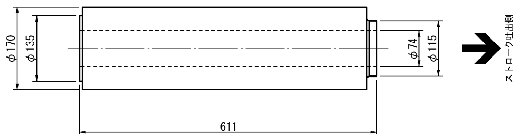
図 7.18 の続き センターホールジャッキの形状・寸法 (全 18 タイプ)
