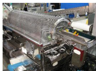
機設の洗浄機「スパイラル」
