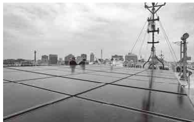
船上に設置されたソーラーパネル
