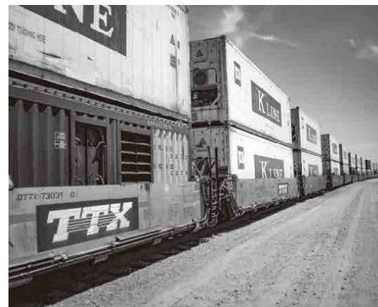
手前の下段のコンテナがパワーバックユニット (PPU)
