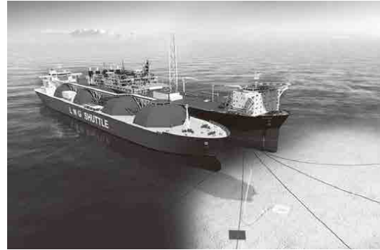
LNGPの荷役の概念図
