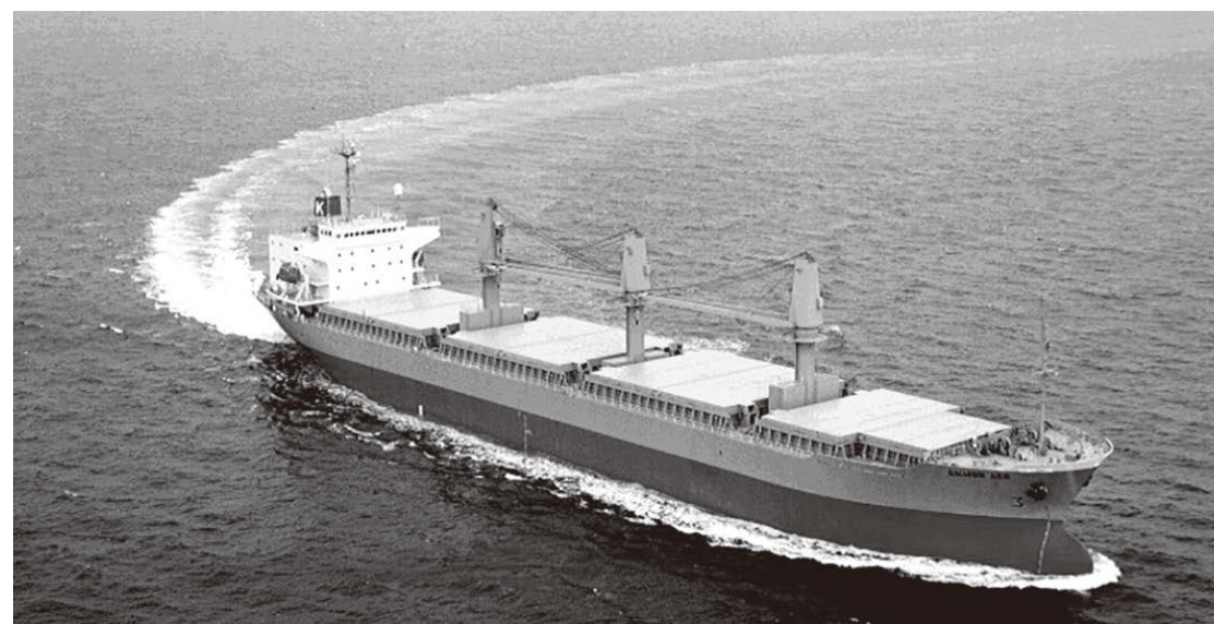
2万3,000DWTのオープンハッチボックスシェイプバルカー AMMON ACE
