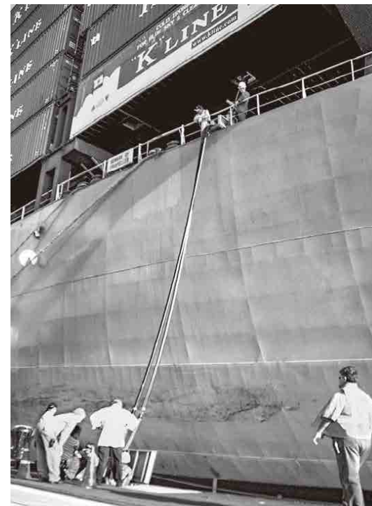
ITSターミナルでの陸上電源への切り替えの様子
