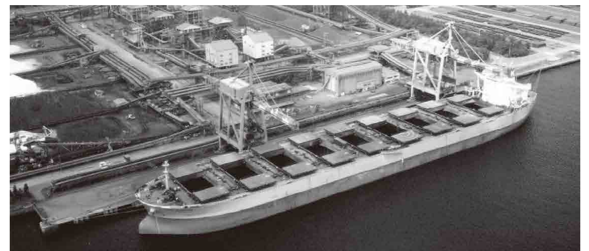
ケープサイズバルカーの鉄鋼原料の荷役
