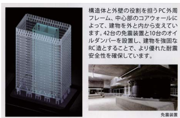
図8 RC免震構造
