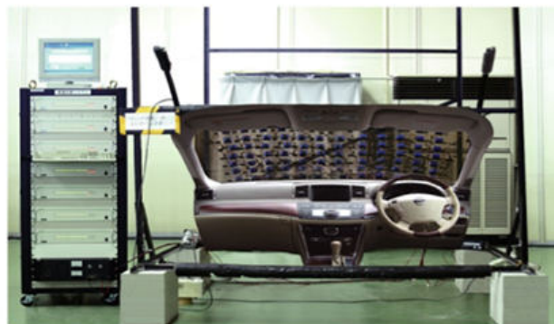
▲風速計測システム
