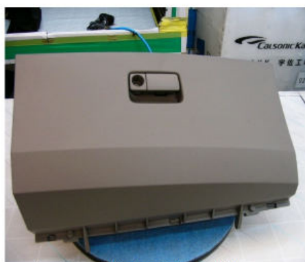
▲ コンソールボックスの外部の塗装
