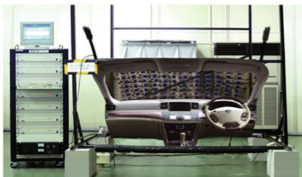
▲風速計測システム
