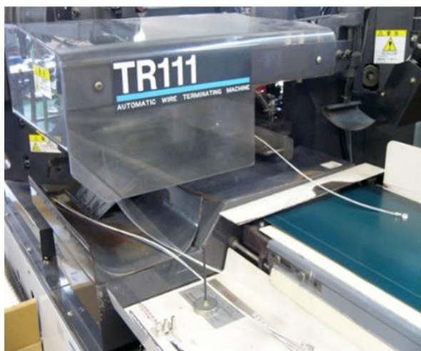
▲ ワイヤを必要な長さに自動でカットして端子をつける装置
