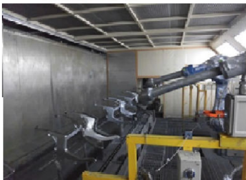
▲ 塗装ライン(フローコンベヤー)
