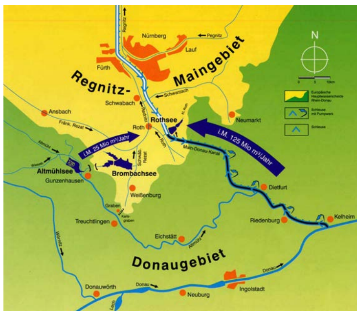
図 6.44 ドナウ川流域からメイン川流域への送水プロジェクトの概要
