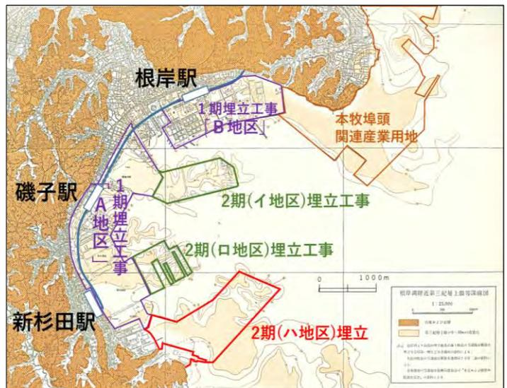
根岸湾埋立は、強固な地層(第三紀層：図中 )が水深10mまで露出している浅瀬を埋め立てている。
