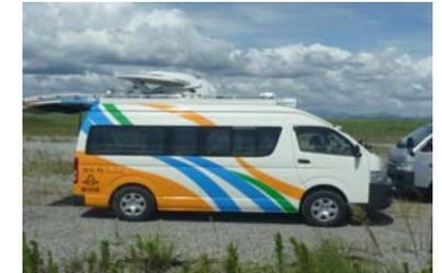
**衛星通信用移動中継車**
