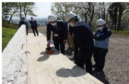
鉄筋探査のデモンストレーション
