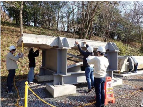
写真-3 鉄筋コンクリート床版のひび割れ計測
