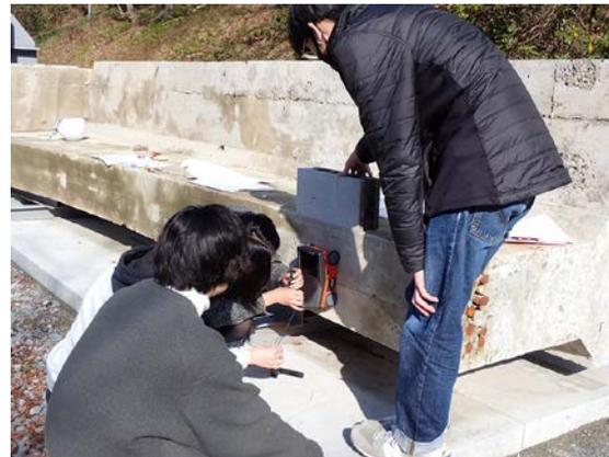
写真-4 鉄筋コンクリート桁の鉄筋探査の様子
