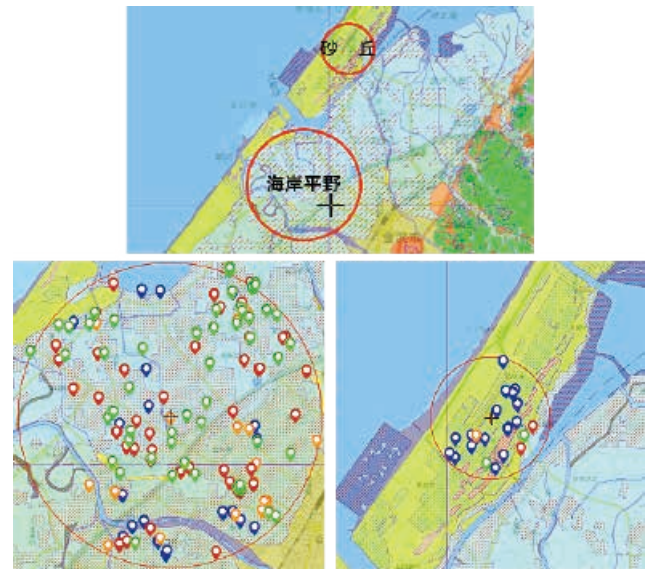
図-10 海岸平野（左）と砂丘（右）の地盤補強状況 6)
