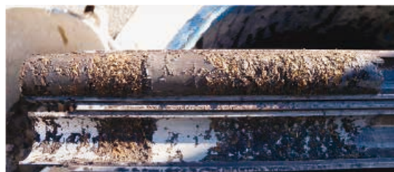
写真-2 SPT サンプラーによる試料採取状況（腐植土）
