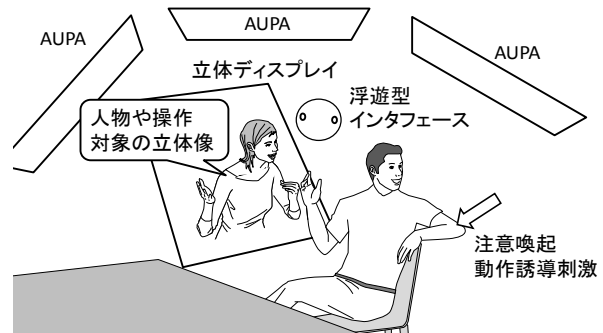
図2 空中触覚テストベンチの基本構成
