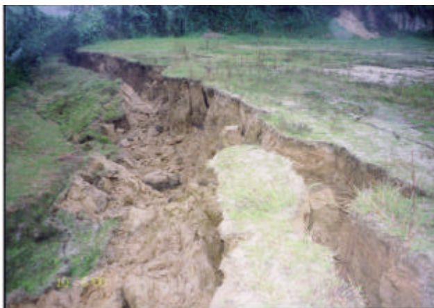
写真-5 西伯町法勝寺中学校軟式野球上のテンションクラック
