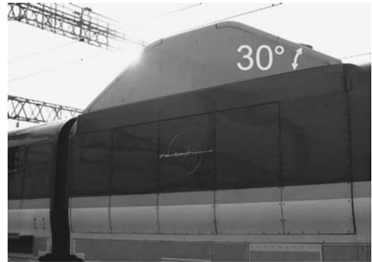
図20 可動式パンタグラフ遮音板 (FASTECH360Z)
