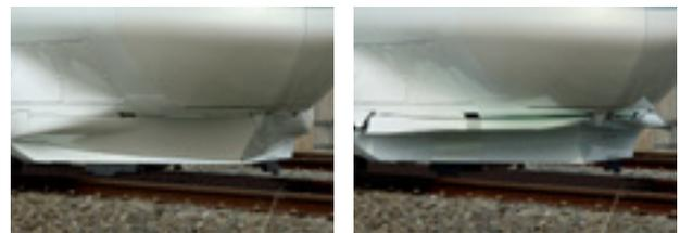
図6 スノープラウカバー (左: 閉状態 右: 開状態)
