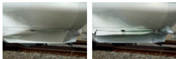
図6 スノープラウカバー（左：閉状態 右：開状態）
