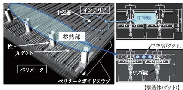
図 - 3 躯体蓄熱システム (STS) と実測比較検証の結果
