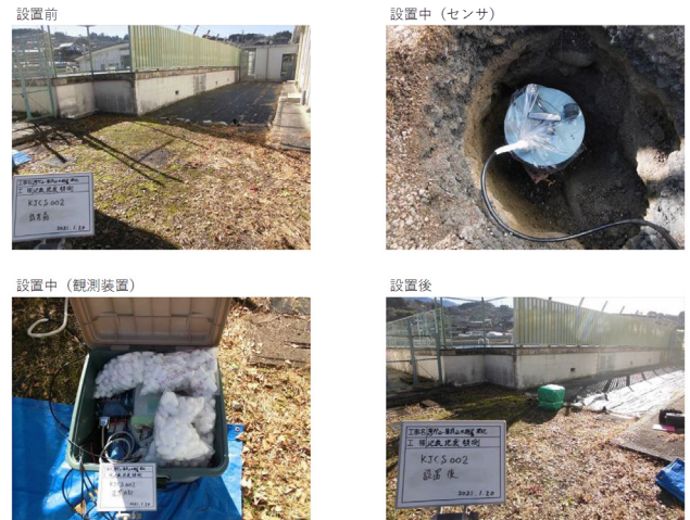
地震観測地点分布図 (20カ所) と地震計設置状況 (中津川市・落合中学校)
