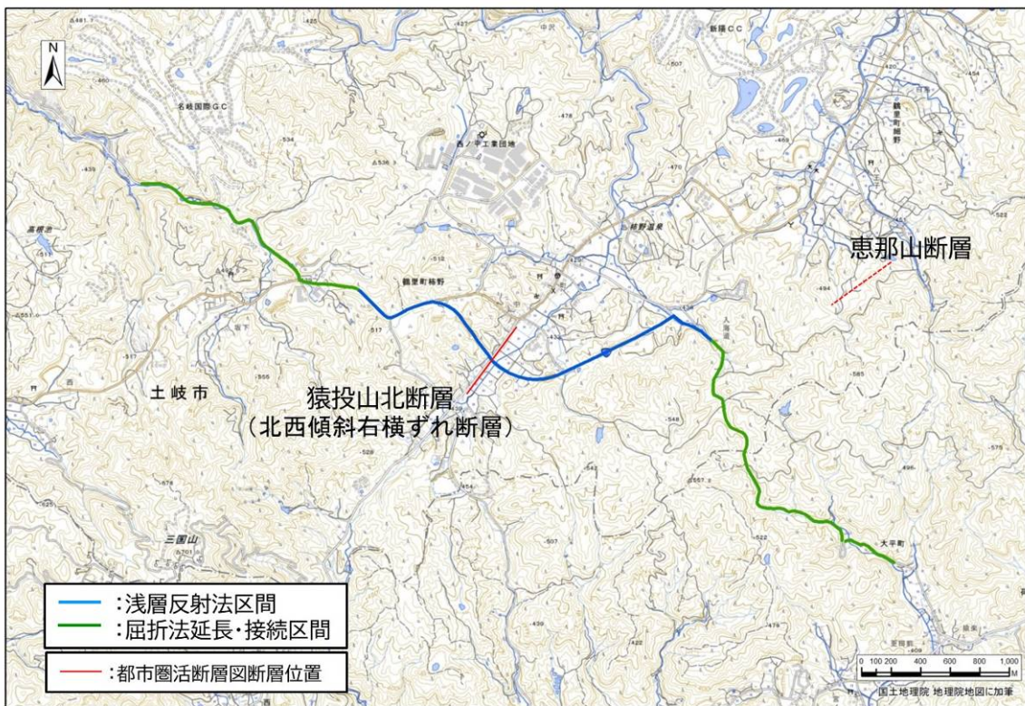
図5 測線2 (長さ約 7.0 km)。国土地理院の地理院地図に都市圏活断層図 (岡田・他, 2017) の断層の地表トレースを参照して加筆。
