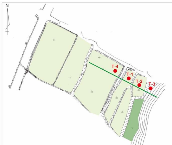
図3 恵那山断層富田地点における群列ボーリングの配置図。 基図は現地での測量結果に基づく。
