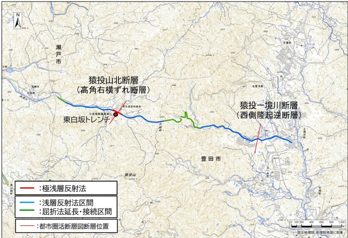
図4 測線1 (長さ約 5.4 km)。国土地理院の地理院地図に都市圏活断層図 (岡田・他, 2017) の断層の地表トレースを参照して加筆。
