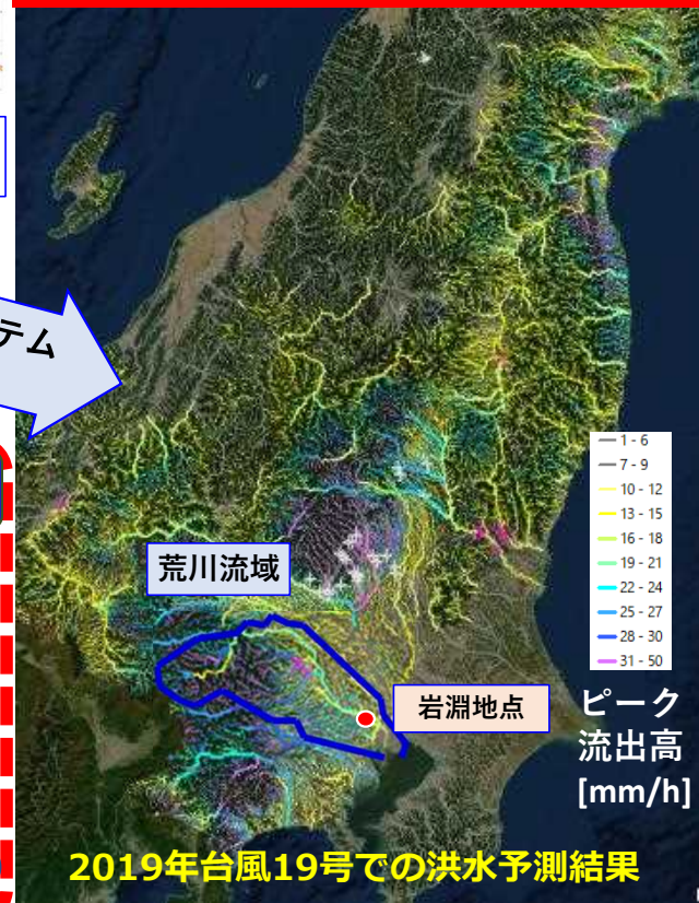
荒川での長時間アンサンブル水位予測 (岩淵水門(上))
