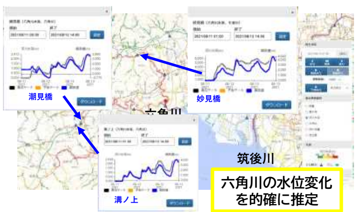
広域洪水予測システムによるリアルタイム現況計算と予測(水深)2021年8月14日(土曜日)7時:六角川
