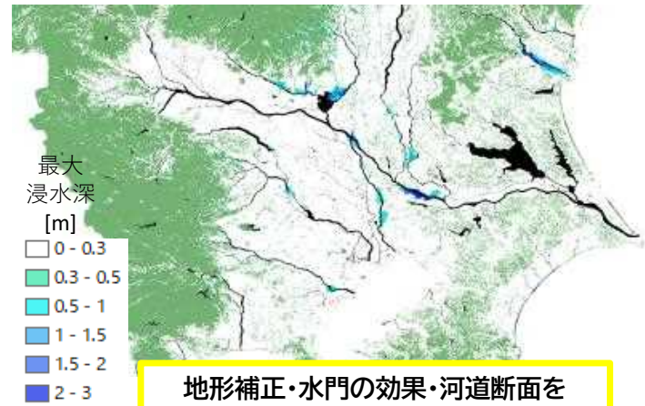
2019年台風19号時の解析雨量を入力した広域洪水予測システムによる 浸水深分布 の推定結果
