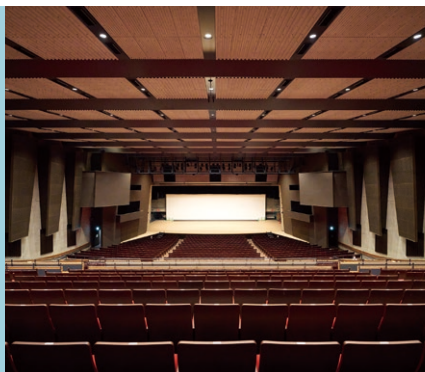
大ホール* 改修により残響時間が延び、音響性能が向上。出演者からも「音が良くなった」というご意見をいただいています。
