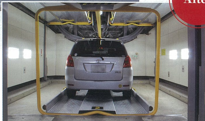
▲ミニバンも入庫可能になった改造後の「メッキ折り曲げパレット」
