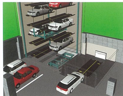
▲ バスエレベータパーキングの出入庫部分
