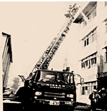
大井出張所に配置された初代18メートル級はしご付消防ポンプ自動車
