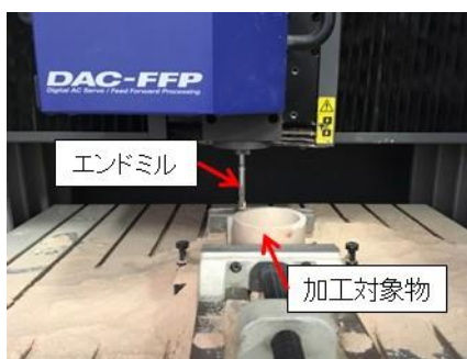
図1 3次元切削加工機の概要写真
