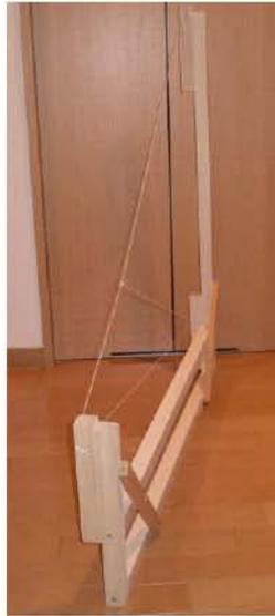
試作したミニ子午線儀
