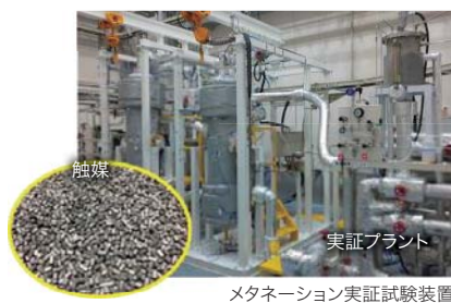
メタネーション実証試験装置
