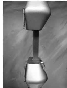
熱可塑性炭素繊維複合材料の引張試験
