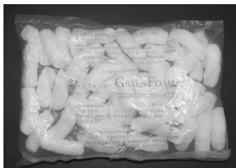
天然物由来素材と生分解性プラスチックを使った 生分解性発泡素材 (開発品)
