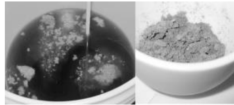
電子基板浸出液の吸着処理と得られた粗貴金属
