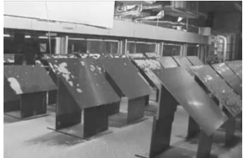
人工降雪装置での塗料の着氷試験
