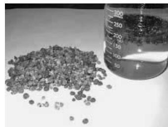
廃棄物を用いた発泡セラミックスの試作品
