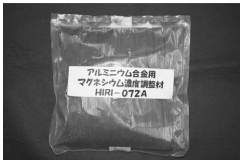
開発したマグネシウム濃度調整用フラックス
