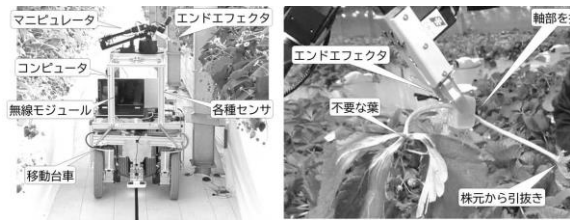
ハウス栽培管理作業用遠隔操作ロボット
