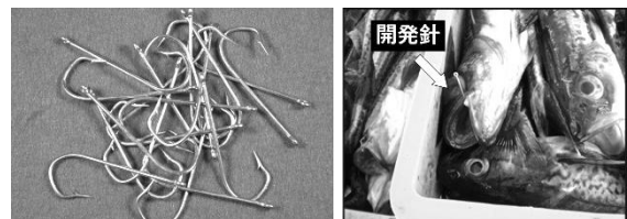
開発した鉛フリー延縄漁業用釣針と釣獲性能試験後の写真
