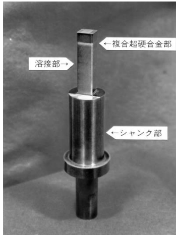
傾斜組成超硬合金を用いた 圧粉体成形用パンチ
