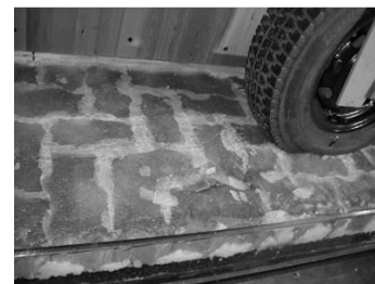
路盤モデルの氷の剥離性評価試験
