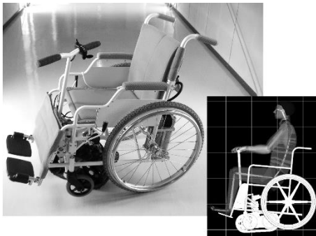
車椅子雪上補助動力と操作シミュレーション
