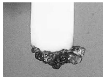
熱可塑性プラスチック/ゼオライト複合材の 発泡炭化層の形成
