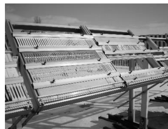
ポリ乳酸樹脂などの屋外暴露試験
