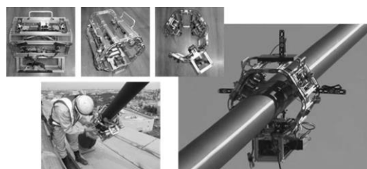
斜張橋ケーブル点検用昇降機構
