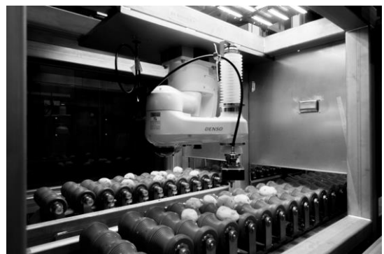
ロボットによるじゃがいも芽取り装置
