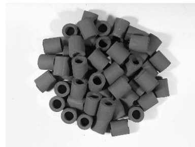
廃乾電池亜鉛滓を利用した水処理浄化材
