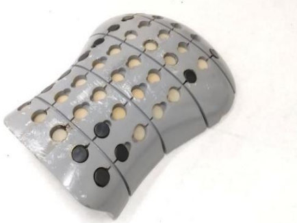
体圧分布計測用の下腿部樹脂モデル
