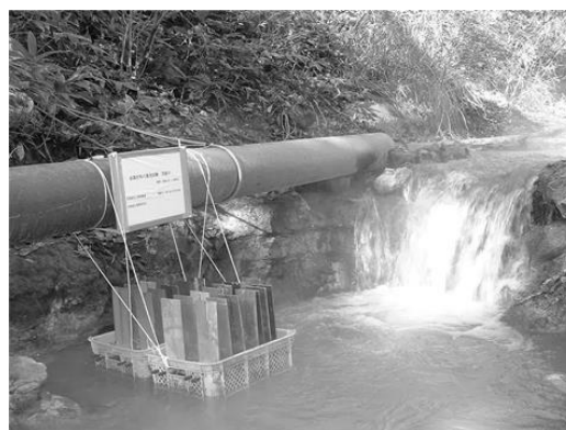
登別大湯沼へ設置した暴露試験片
