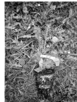
生分解性プラスチックを使った育苗ポットの屋外土中埋設試験
