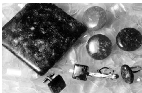
廃蛍光管ガラスを利用したモザイクタイル等の試作品
