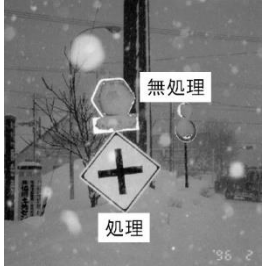
道路標識での試験施工評価
