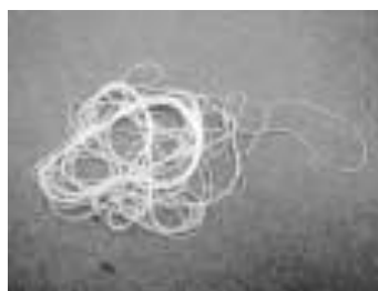
エアギャップ紡糸法で形成したセルロース繊維
