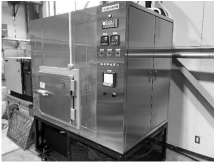
凍結融解試験機の外観（令和3年現在）
