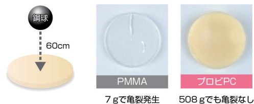
図2 ボールドロップ試験模式図と試験後の試験片
