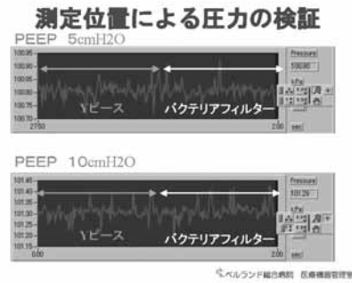
口元にはフローメーターとテスト肺を取り付け、PEEPをかけた状態で三方活栓を切り替えた。右はフローメーターから得られた各部位の圧力波形。測定部位を切り替えても変化は認められない。
