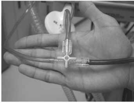
口元にはフローメーターとテスト肺を取り付け、PEEPをかけた状態で三方活栓を切り替えた。右はフローメーターから得られた各部位の圧力波形。測定部位を切り替えても変化は認められない。
