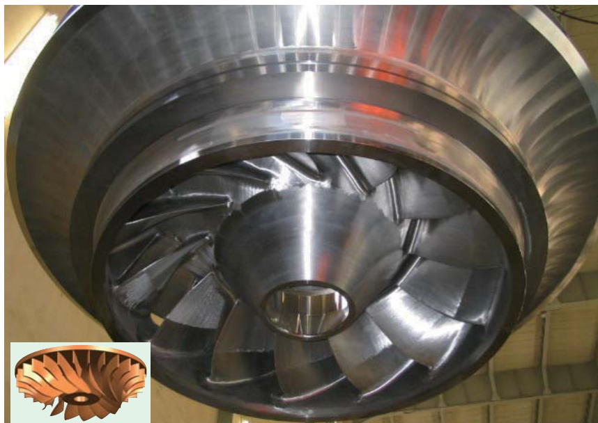
2 北陸電力株式会社新中地山発電所の中間羽根ランナの外觀と三次元 CAD 図 (左下)
