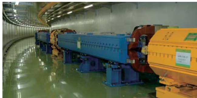
9 J-PARCの50 GeVシンクロトロン電磁石群(写真提供: 独立行政法人日本原子力研究開発機構, 大学共同利用機関法人高エネルギー加速器研究機構)
