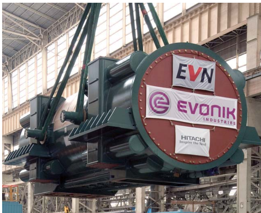
4 ドイツ・Evonik Steag GmbH Walsum 発電所 962 MVA タービン発電機
