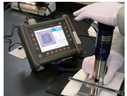
6 塑性ひずみ検出確認試験 (硬さ測定) の状況
