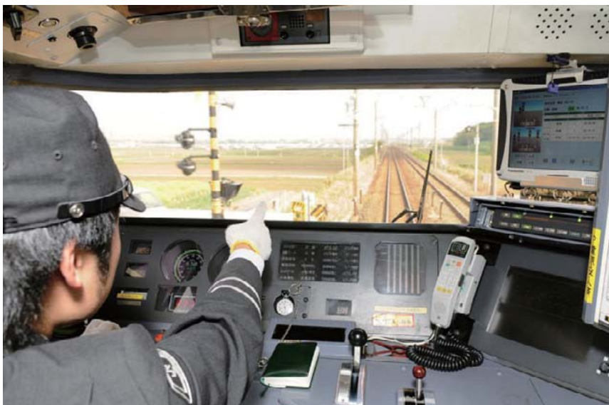
3 運転中の表示端末(写真右上)使用例(写真提供:日本貨物鉄道株式会社)
