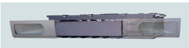
図3 走行風利用水循環冷却方式主変換装置の外観 電動送風機を廃止し、走行風を利用した水循環冷却方式の主変換装置で小型・軽量・低騒音を図った。
