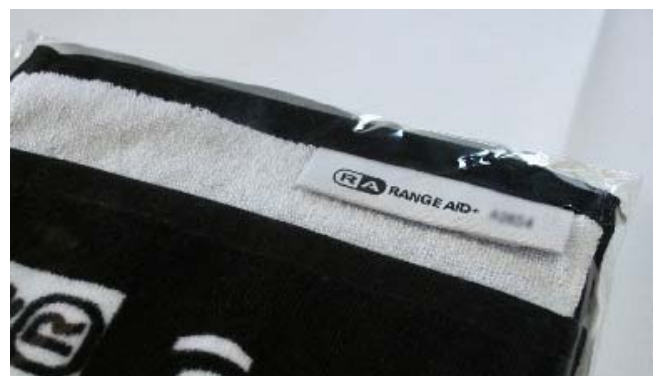
▲ミューチップ入りの IC タグを縫い付けたタオルマフラー
