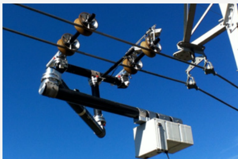
超高压送電線検査装置 Expliner 超高压架空送電線上を自走し、送電線の表面状況や外径寸法を測定する装置
