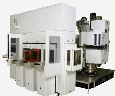
M-8190XT 20nm世代のメモリーデバイス向けハードマスクエッチ、 ダブルパターニング対応マスクエッチなどに対応した エッチング装置
