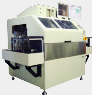
DB900 小型パッケージに対応したフレキシブルダイボンダ
