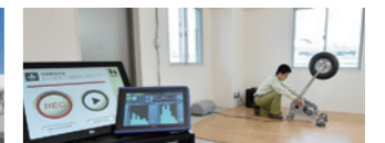
音体感室での遮音実験状況
