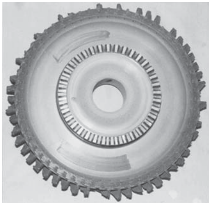
Fig. 4 第1タービン動翼の高温腐食による破損状況
