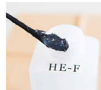
セメントに混ぜる、ゲル状のクレイナノシート。ごく少量で、フレッシュコンクリートに物理ゲルの性能を付与できる。
