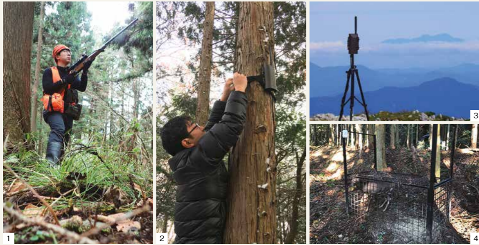
1. 猟に出る森部准教授。現場で得た知見を研究にフィードバックする。 2.3 LPWA通信システムを用いた捕獲支援システム「オリワナシステム」の機器を調査対象範囲に設置。機器はコンパクトで軽量なため、複雑な配線や大掛かりな工事が不要で、移設も容易にできるよう設計している。 4. わなによってシカの捕獲に成功。捕獲情報がクラウド上で瞬時に共有される。
