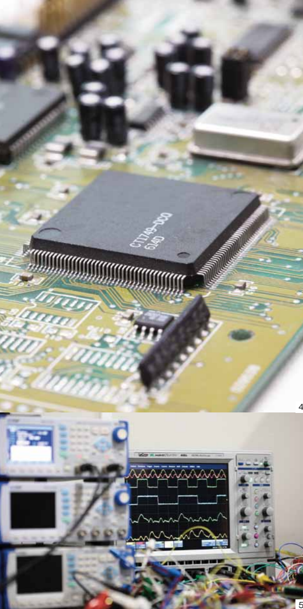
①中央にある2.4mm×2.4mmの四角の中に髪の毛の太さほどの極小の回路が納められている。企業が作った研究用の集積回路。②③断熱的論理回路の設計図。全体図(2)と拡大図(3)。研究室の学生がパソコンでこうした設計図を作り、それをもとに企業が集積回路を作っている。回路の中のトランジスタには通電性のあるもの、ないものとさまざまな素材が使われる。赤い線が電気を通す金属、緑の線が電気を通さないシリコンを示し、白い線は髪の毛の1/100ほどの太さ。こうした極細の線もすべて学生がひとつひとつ描き、完成までに約2カ月要する。実験では電流を回路に流し、トランジスタの切り替えを行いながら動作の様子を検証する。④電卓の中の回路の様子。普段使っているパソコンの中にはトランジスタが約56億個も使われ、トランジスタの切り替えによりさまざまな演算を行いながらパソコンを動作させている。⑤断熱的論理回路の研究に使う交流電流を作る電源生成機器。現在は6台使用、将来的にはこれも極小化し回路に組み込む予定だ。
