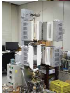
岐阜大学内の電気炉。炭化炉・焼成炉と同じ処理を行った上で、詳細なデータが取得できる。
