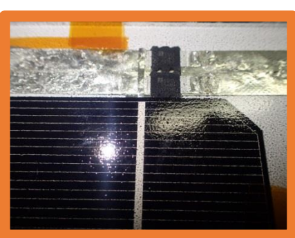
バイパスダイオード内蔵太陽電池パネル
