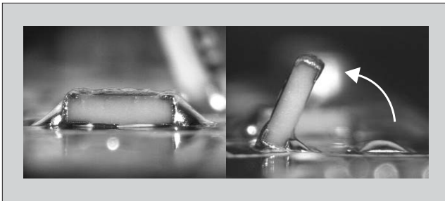
図2 マンハッタン現象の代表例（部品：1608 抵抗）
