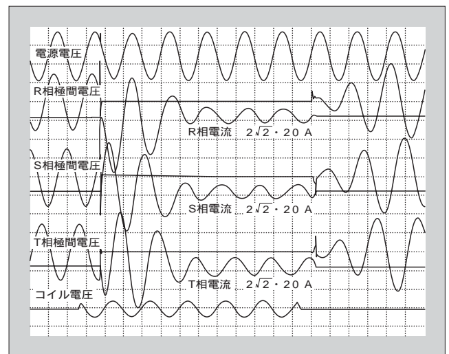
図2 かも形モータを始動、停止した場合のオシログラムの例
