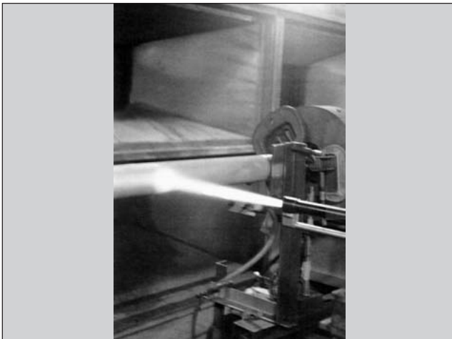
図 16 弁棒のジェットコーティング施工例
